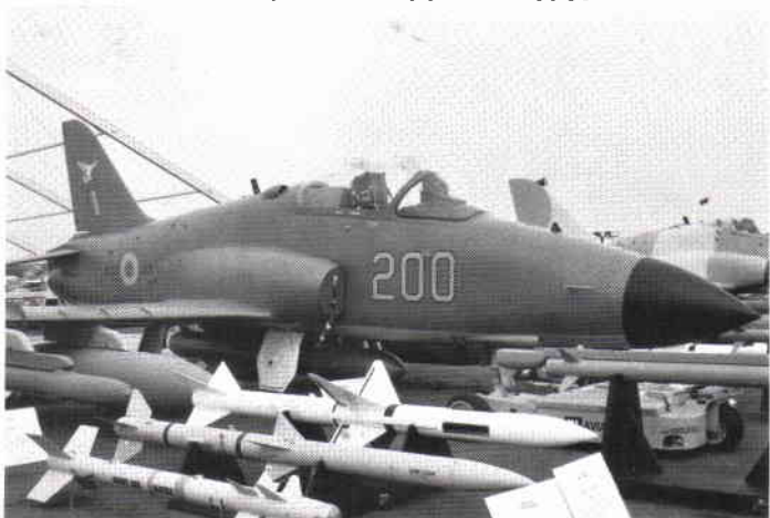
Hawk 200 från British Aerospace är ett ensitsigt lätt attackplan som även ska kunna utföra vissa luftförsvarsuppgifter
