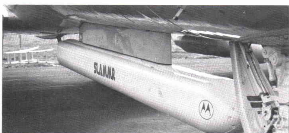
SLAMMR upphängd under kroppen på Fokker F-27
